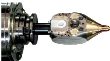
El dispositivo híbrido LMD y CNC del AFRC.
