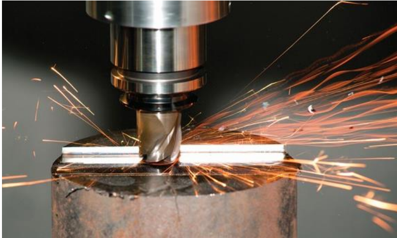
Fresa de cerámica perforando acero
