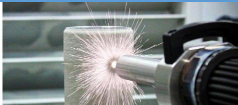
Espray en frío de Impact Innovations en funcionamiento
